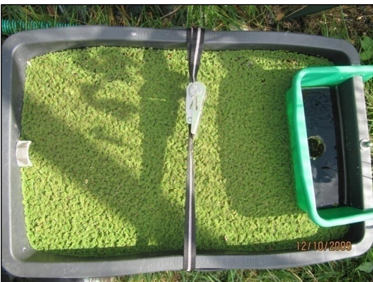
Figura 3. 16: Tercer reactor con Azolla de la planta piloto para la determinación de la remoción de nutrientes (Año 2009).
