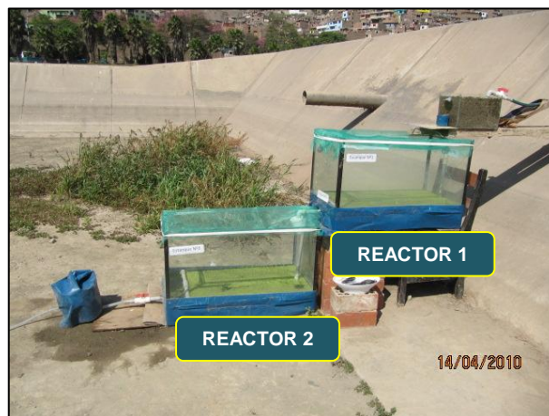
Figura 4. 69: Estanques con Lemna Minor para los sistemas de “flujo continuo” (CITRAR- Año 2010)
