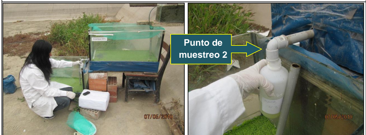
b) Toma de muestra de la 1ra salida (Punto N°2) luego del 1er reactor.
