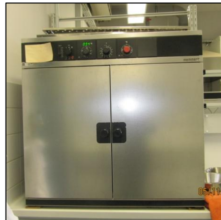
Figura 3. 24: Mufla para una temperatura de 550°C (Año 2009).
