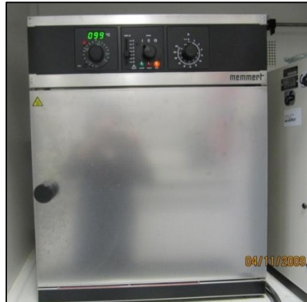
Figura 3. 22: Vista exterior de la Estufa utilizada a una temperatura de 105°C (Año 2009).
