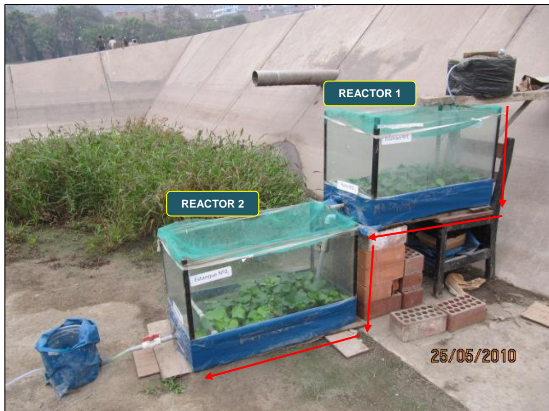
Figura 4. 58: Estanques con Sistemas de “flujo continuo” cubierto con Eichhornia crassipes ubicada en CITRAR-UNI (del 24 de Mayo al 4 de Junio del 2010)
