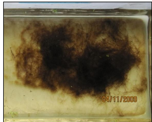
Figura 3. 30: Rizomas y lodo depositado mediante la acción de sedimentación, después de retirarse el medio (Año 2009).
