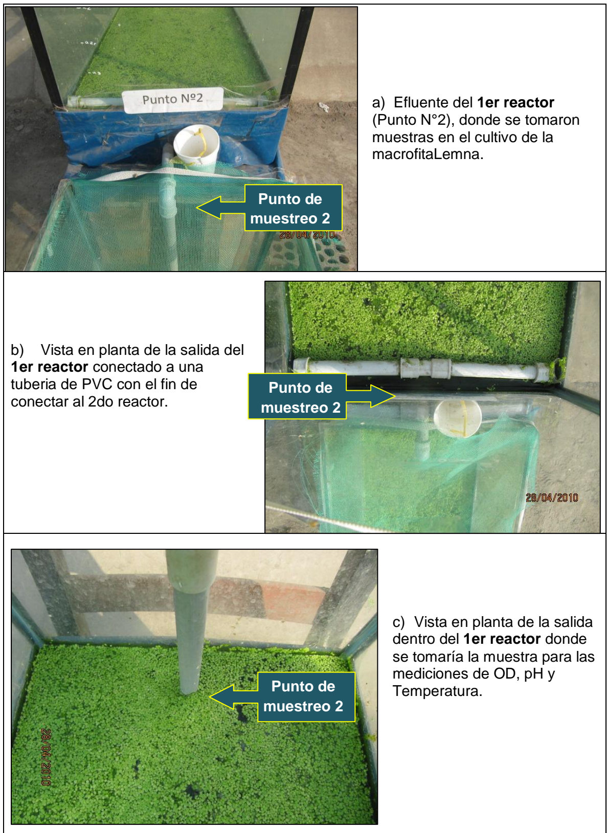
Figura 3. 45: Segundo punto de medición del sistema de tratamiento (CITRAR-Año 2010)
