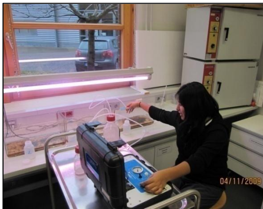
Figura 3. 29: Extracción del medio mediante una bombilla, dejando a las rizomas y al lodo depositado en cada acuario (Año 2009).
