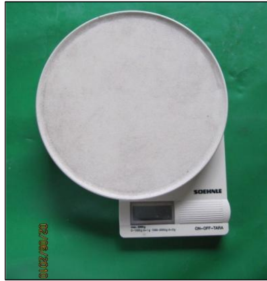
Foto.6. Balanza utilizada en el laboratorio CITRAR para la medición de los pesos de las plantas acuáticas.
