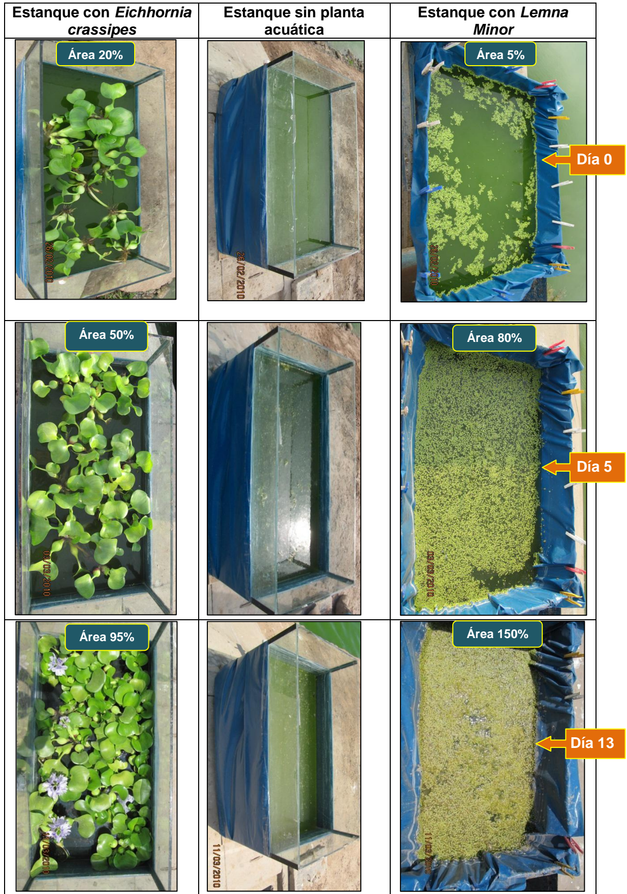
Figura 4. 43: Comportamiento de los sistemas por tandas ubicadas en CITRAR, sin planta acuática, con L. Minor y con E. Crassipes (Año 2010)
