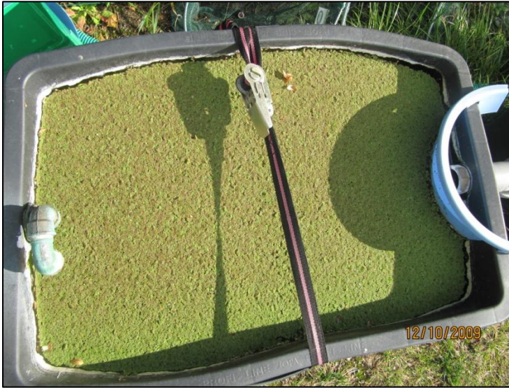
Figura 3. 14: Primer reactor con Azolla del segundo experimento para la determinación de la remoción de nutrientes (Año 2009).
