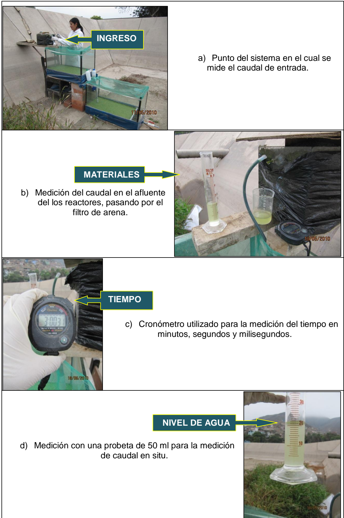
Figura 3. 42: Medición de Caudal en el afluente del sistema de remoción (CITRAR-Año 2010)
