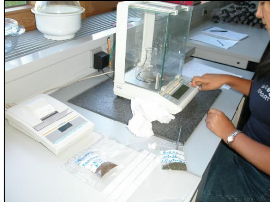
Figura 3. 20: Vista de la balanza electrónica utilizada para la medición de los pesos en cada capsula (Año 2009).
