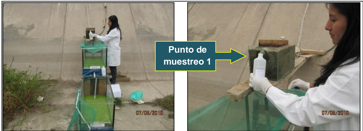
a) Toma de muestra del afluente (Punto N°1) luego del filtro de arena.
