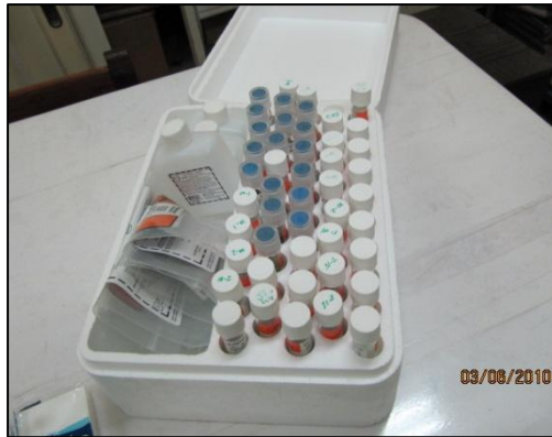
Foto.9. Set de prueba para las mediciones de los nutrientes: Fósforo total y Nitrogeno Amoniacal.
