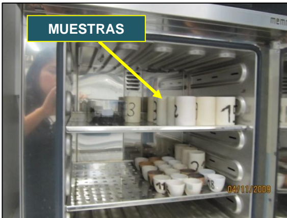
Figura 3. 23: Estufa para una temperatura de 105°C (Año 2009).
