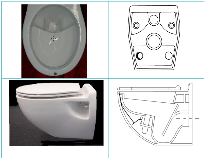
Figura . La separación de la orina de las aguas de aseo en los sistemas de alcantarillado. Fuente: Vakuum R. y Haustechnik Hanau (2001)
