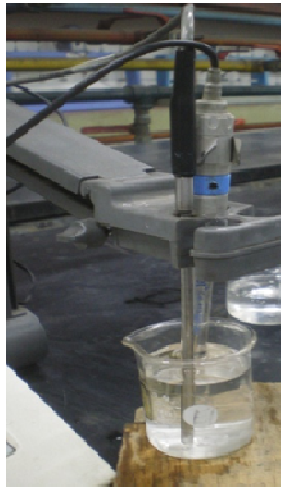
Figura 8 Electrodo del pH-metro sumergido en una muestra de agua Fuente. Laboratorio de Físicoquímica – Facultad de Ingeniería Ambiental/ Universidad Nacional de Ingeniería
