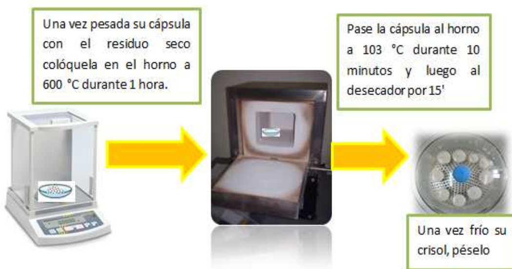
Figura N° 9. Determinación de sólidos volátiles y sólidos fijos en laboratorio Fuente. Elaboración propia en base a la guía “Análisis de agua y desagüe” – Enrique Jimeno Blasco
